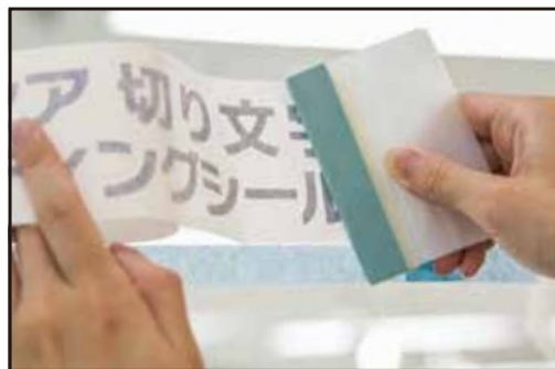
⑤ 从中间开始向边缘刮压，用刮板施加压力以排出水分。
