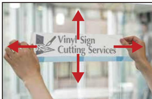
④ 将贴纸对准标记。揭开转移膜, 并用刮板将文字贴纸粘贴到表面。
